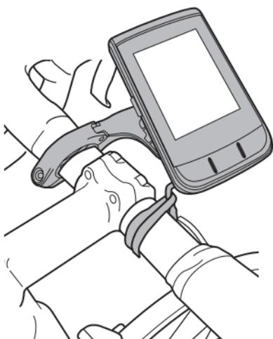
Gire el dispositivo en sentido horario hasta que el dispositivo y el soporte emitan un chasquido que indica que quedan bien fijados uno a otro.
