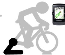
SGX-CA600の「シミュレーション」機能を使うと、コースの勾配情報に合わせてスマートトレーナーの重さが自動的に変わります。
