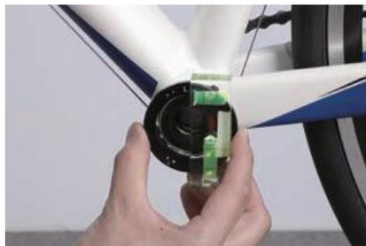
7 六角レンチ(2mm)を使用して、ネジ(3つ)を均等に締め付けて固定します。
