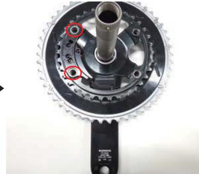
**4 チェーンリングボルトをボルト穴にグリスを塗布後に挿入し、チェーンリングとチェーンリングアダプターを仮止めします。仮固定するときは、チェーンリングボルトを最後まで締めず、チェーンリングがまだ動く状態にしてください。**
