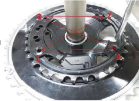
矢印の方向に力を加えて遊びをとりながら、チェーンリングボルトを締め付けます。
