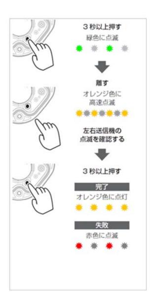
右送信機にあるプッシュスイッチを3秒以上押すと、右送信機のLED が緑色に点滅を開始します。左送信機と通信できると、左右送信機のLED がオレンジ色に高速に点滅し始めます。モードを切り替える左右送信機のLED が点滅していることを確認してください。(点滅していない時は、他のペダリングモニタセンサーと誤って通信している可能性があります。他の自転車とは、離れた場所に移動してから再度、操作を行ってください。)10 秒高速に点滅するのでその間に再度、3 秒以上押してください。デュアルパワーメーターモードに切り替えできます。切り替わるとLED がオレンジ色に10 秒点灯します。LED のオレンジ色の高速点滅中に長押ししないとキャンセルされますので再度、操作を行ってください。
