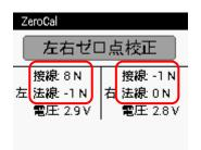
数値が範囲外の場合は、クランクが動くなど安定しない状態 で校正が行われた可能性があります。 クランクを静止させた状態で再度ゼロ点校正を行ってください。
