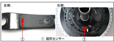
取り付け位置(磁気センサーの通過位置)の目安
