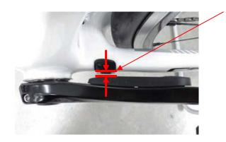
左側、右側ともにマグネットとセンサーの距離 が 1.5mm 以上、10.7 mm 未満 であることを確認します。 上記の範囲内に入らない場合は、シートチューブ(写真右) または、ダウンチューブ に取り付けて、マグネットと 磁気センサーの距離が範囲内に 入っていることを確認します。 範囲外の場合は、アームタイプ マグネットを使用します。
