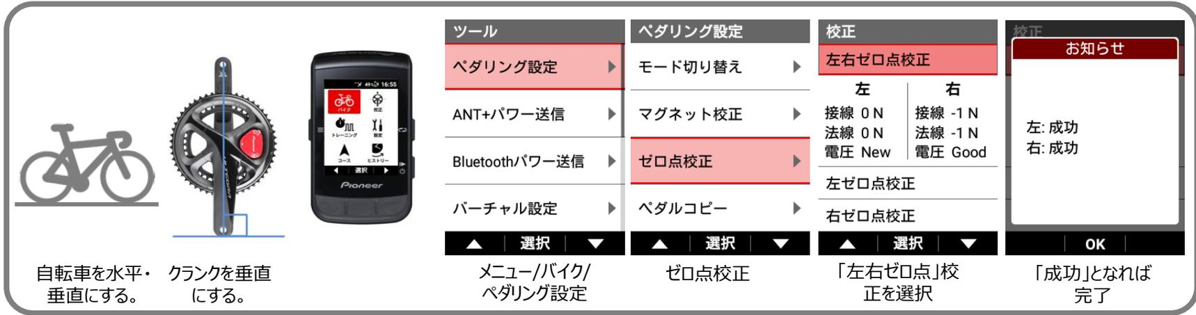
この図は、SGX-CA600のゼロ点校正の手順を示しています。左側には自転車を水平にし、クランクを垂直にするためのイラストが示されています。中央にはSGX-CA600のディスプレイ画面が写っており、右側にはそのメニューのスクリーンショットが示されています。
