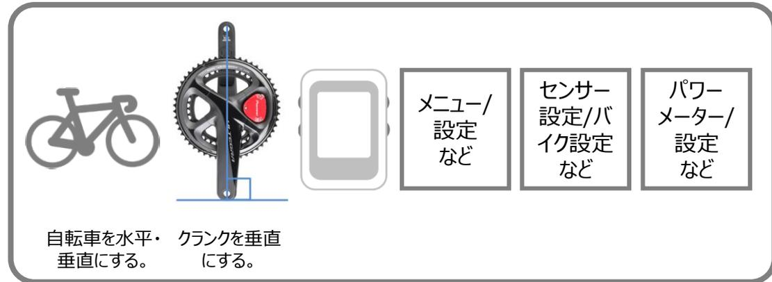
この図は、ANT+サイクルコンピューターでのゼロ点校正の手順を示しています。左側には自転車を水平にし、クランクを垂直にするためのイラストが示されています。右側にはスマートフォンと、メニュー/設定、センサー設定/バイク設定、パワーメーター/設定などの設定項目が示されています。
