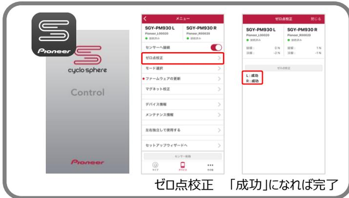
この図は、Cyclo-Sphere Control Appでのゼロ点校正の手順を示しています。左側にはAppの起動画面が写っており、右側には「ゼロ点校正」のメニュー画面と「成功」のメッセージ画面が写っています。
