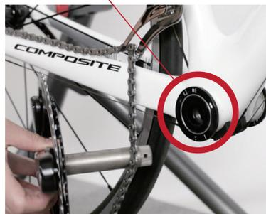
Une bague à aimant installée sur le support inférieur contient des aimants à 12 endroits différents. L'appareil détecte les aimants à l'aide d'un capteur de magnétisme, et mesure ainsi avec précision la "force" et le "sens de la force" tous les 30° de rotation.
