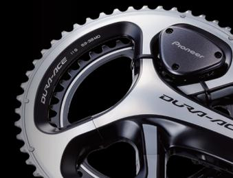
Les capteurs indépendants de droite et de gauche sont installés sur le côté intérieur du bras de manivelle, et permettent ainsi de mesurer indépendamment la "force" et le "sens de la force" côté gauche et côté droit.
