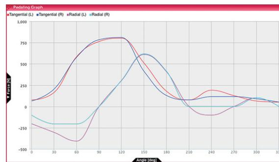
L'axe horizontal représente la position de la pédale (la position verticale correspondant à un angle de 0°C), et l'axe vertical représente la puissance ou le couple. La ligne tangentielle des durées de pédalage gauche-droite et la magnitude de la force d'avancée peuvent être affichées. La répartition du couple et de l'équilibre gauche-droite pendant chaque tour de pédale peut ainsi être facilement vérifiée.
