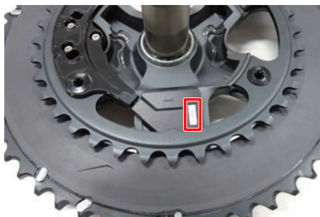
Lato destro: Scatola di giunzione
